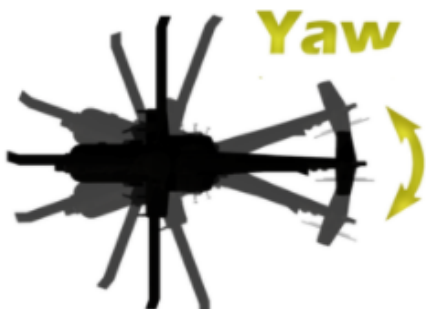
Afbeelding 4: Stuurmotor helikopter. "yaw movement" is de Engelse term voor rotatie om de verticale as.
